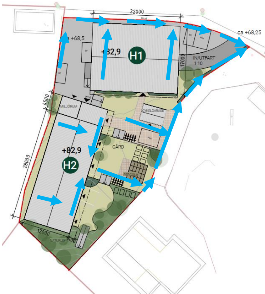
Figur 19 Förslag på hur skyfallsvattnet kan avledas från planområde vid extremregn. Blåa pilar visar ytlig avrinning.
