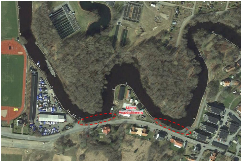
Figur 5. Aktuellt avsnitt av Sävåån. Röda streckade ovaler markerar erosionsskydd.
