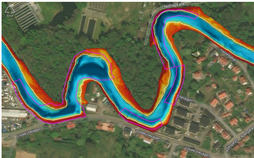
Figur 12. Batymetri. Lila polygon visar områden med erosion. Mörkblå botten är djupare, där stranden är utsatt för erosion. (Figur: Marcon Teknik).
