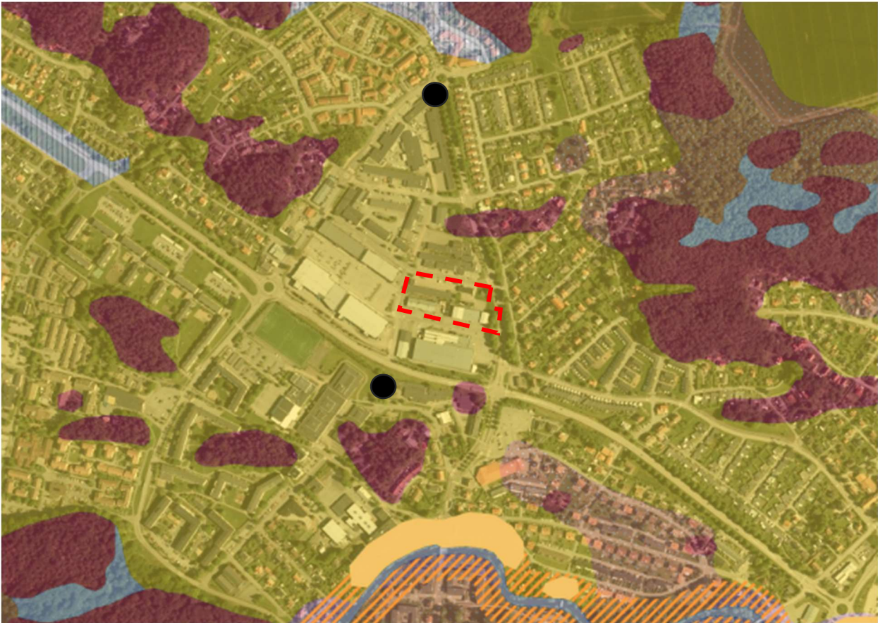
Figur 5 Utdrag ur SGU:s jordartskarta inklusive lager "förutsättningar för skred i finkornig jordart. Ljusgula ytor markerar jordlager lera och röda ytor markerar ytligt berg. Skrafferad och gul markering längs Sävveån indikerar att risk för skred i finkornig jordart föreligger. De runda svarta ringarna visar var kolvprovtagningar tidigare utförts.
