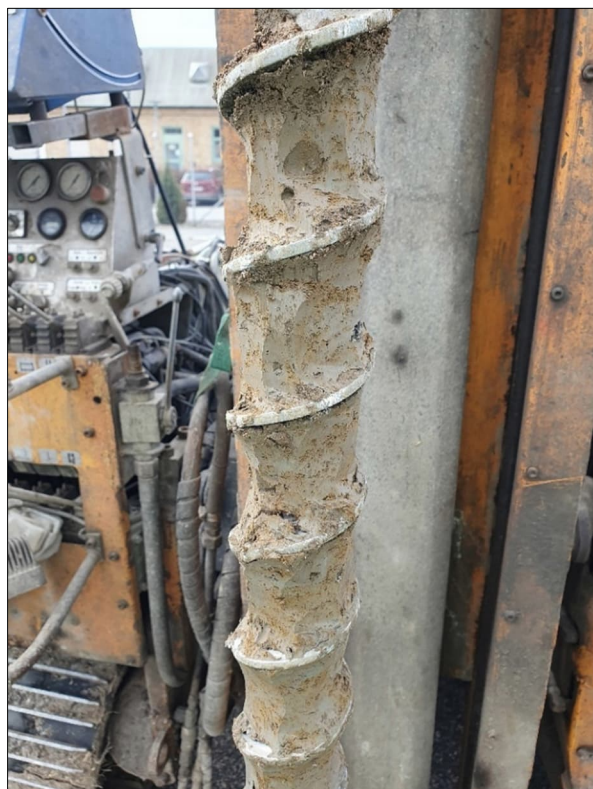
Figur 7. Fyllnadsmaterial bestående av lera med litet inslag av grus och sand i punkt NC2309 på nivån 1,0-1,5 m u my.
