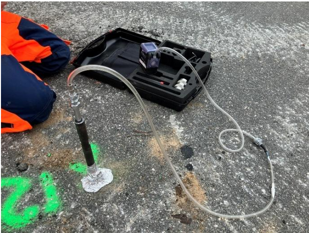
Figur 8. Porgasprovtagning 2025-08-27 av Systra AB i provpunkt 25SY12.
