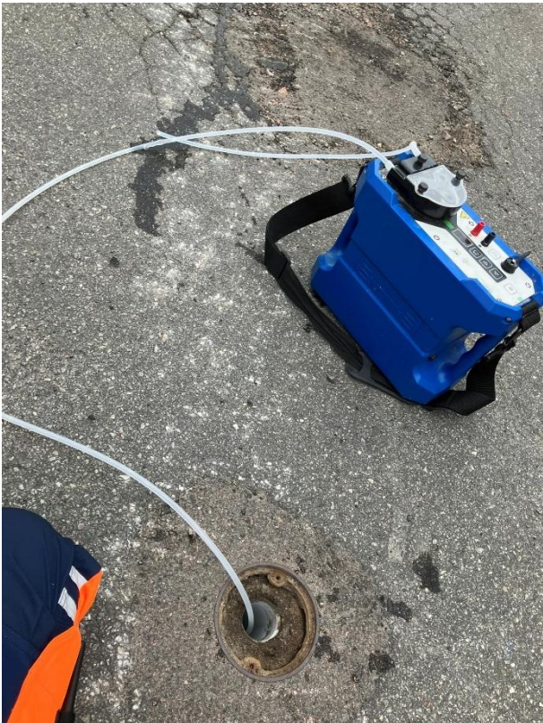
Figur 7. Grundvattenprovtagning 2025-09-04 av Systra AB med peristaltiskpump i provpunkt SW2401.
