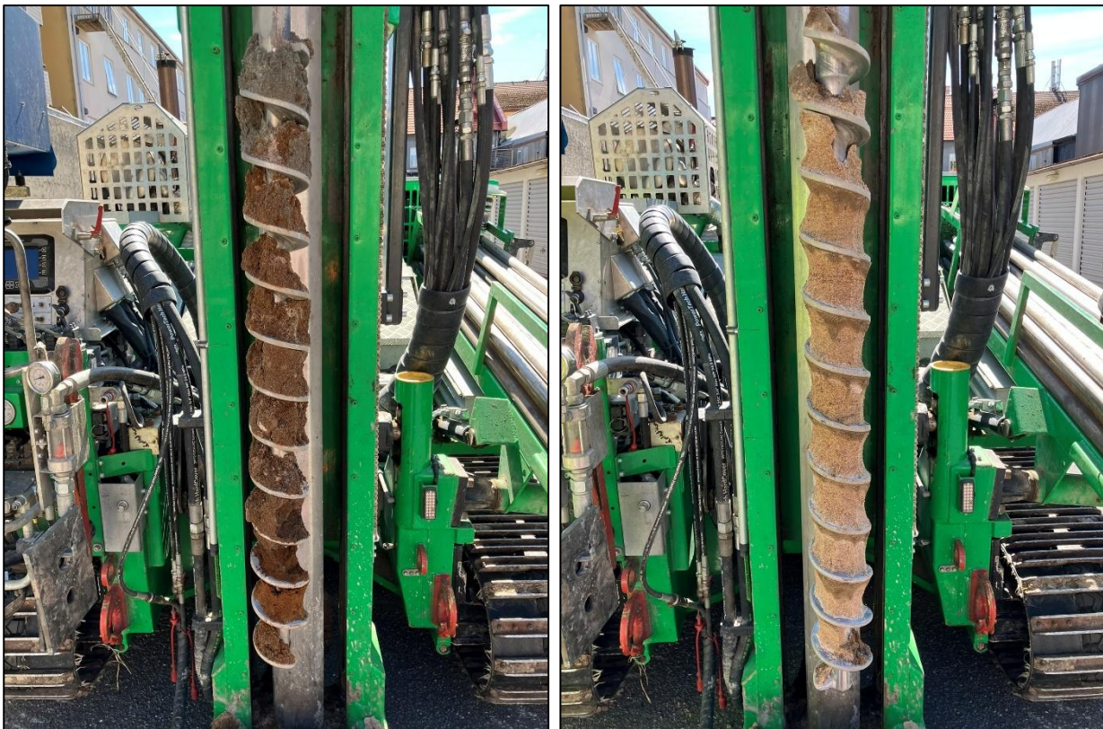
Figur 6. Exempel på borrarprov från Systras undersökning som visar fyllnadsmassor till vänster och naturlig avsatt sand till höger. Vänster: 25SY03 0-1 meter. Höger: 25SY03 2-3 meter.
