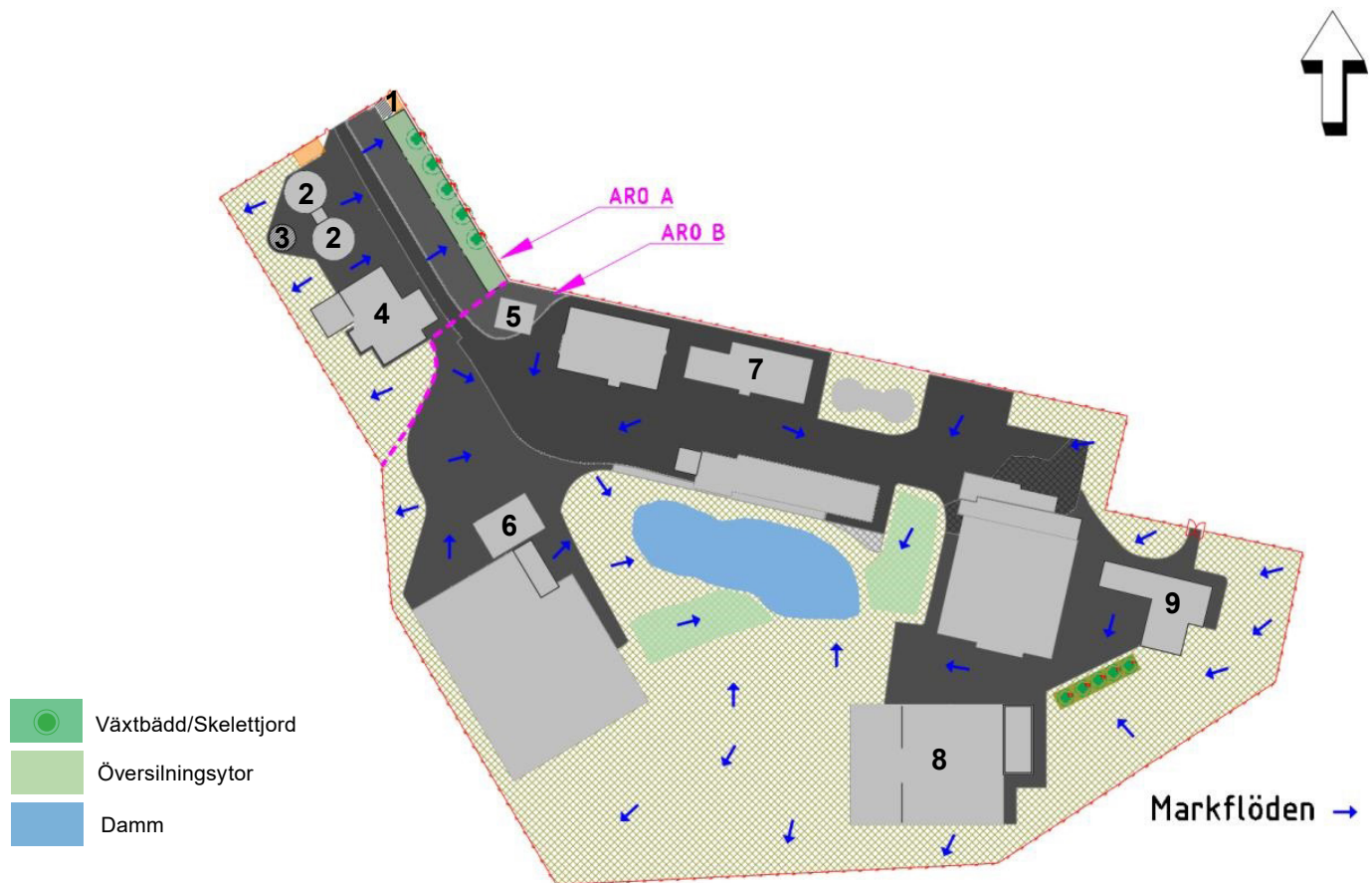
Figur 12. Föreslagen dagvattenhantering med markflöden utifrån ett möjligt scenario efter ombyggnationen. Val, placering och utformning av anläggningar ses över i detaljprojekteringen. Ny bebyggelse är markerad med siffror.
