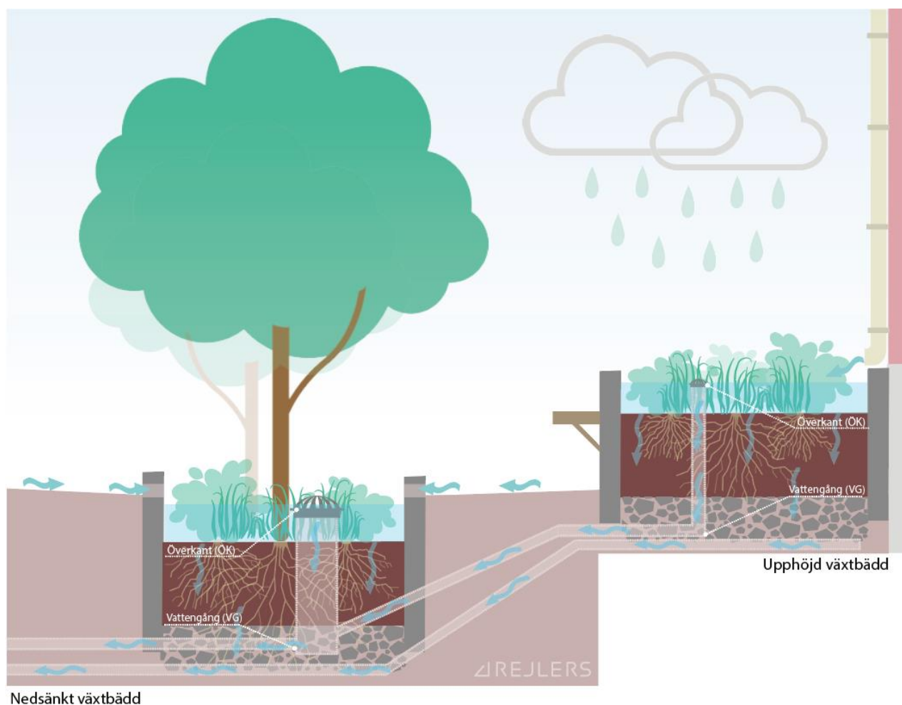
Figur 28: Nedsänkt- och upphöjd Regnbädd/Biofilteranläggning.
