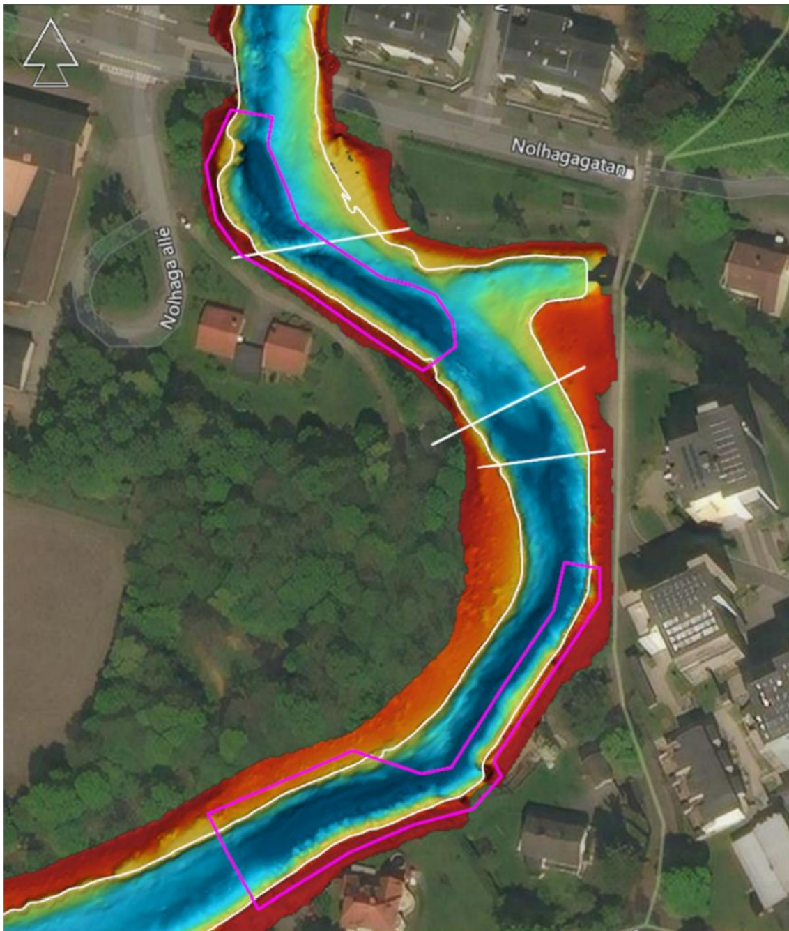
Figur 2. Områden med större erosion, visade med lila linjer. Vita linjer markerar korsande ledningar. Mörk blå färg visar större vattendjup. Figur: MarCon Teknik AB
