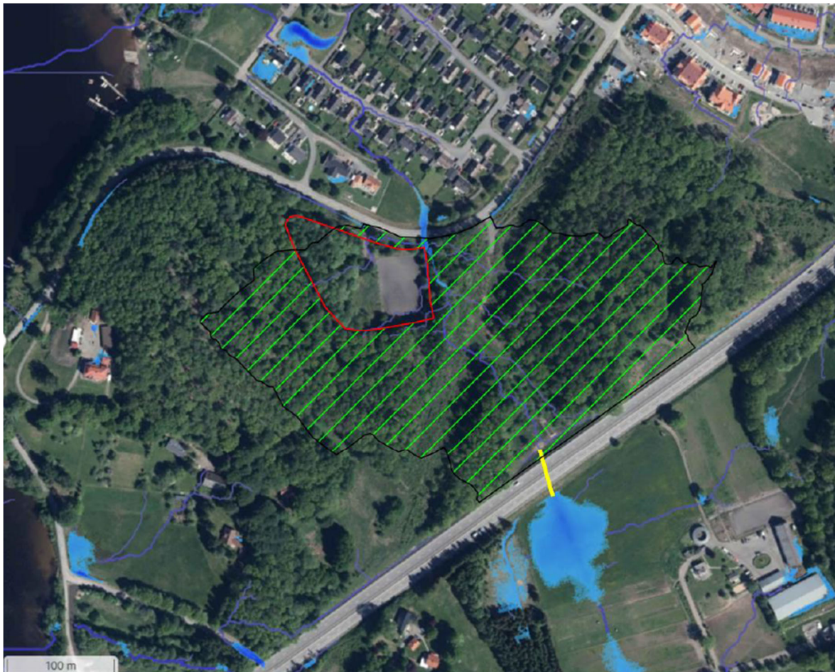
Figur 23. Lågpunkter nedströms och uppströms utredningsområdet (röd linje), kulvertar uppströms (gul linje) samt avrinningsområdet med tillkommande vatten till bäck (grön skraffering).
