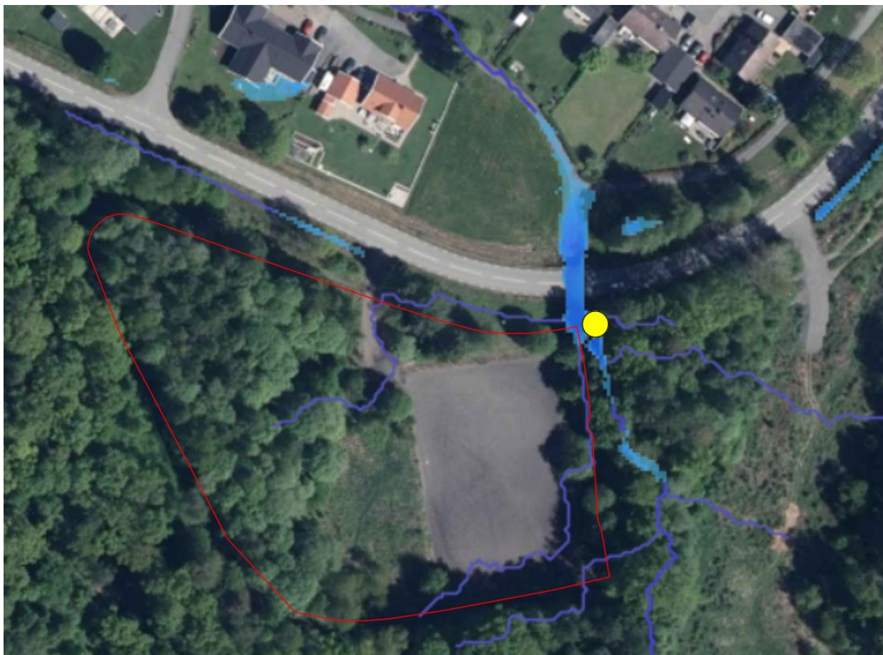
Figur 3-7. Lågpunkter i nära planområdet blått, gul cirkel visar läget för början av 400mm kulvert under väg och bostadsområde.
