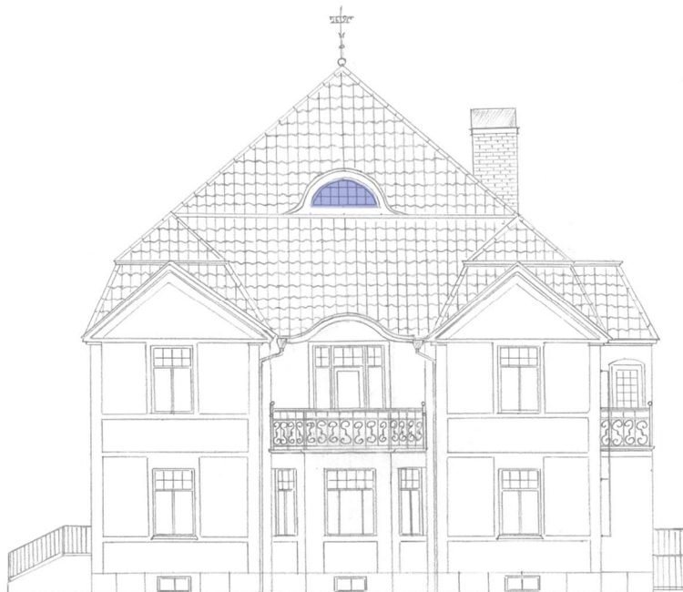
Figur 4. visar fasad mot norr med markerade fönster till bedömda kritiska rum.
