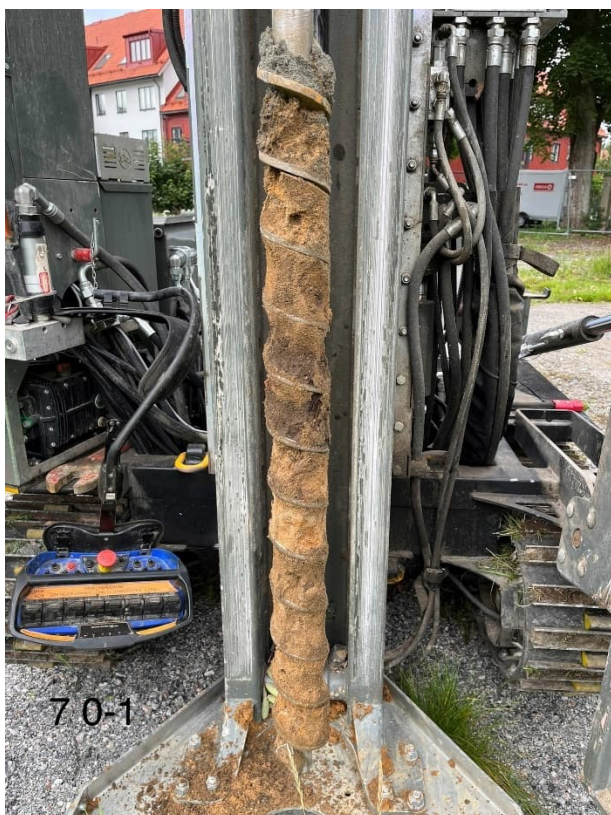
Figur 7. Provpunkt 23NC07 på 0–1,0 m u my. I övre halvmeteren påträffades tegel- och trärester.
