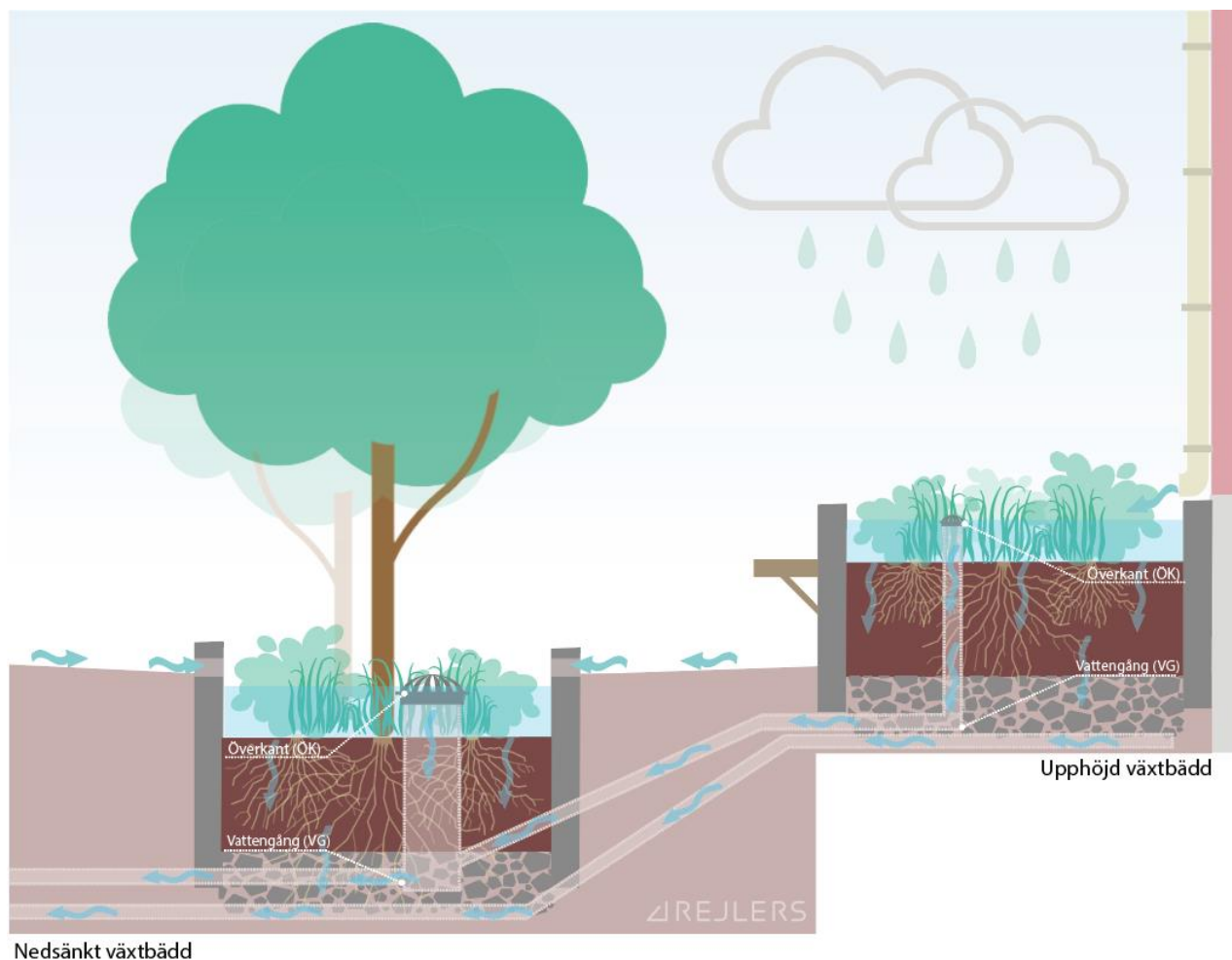
Figur 28: Nedsänkt- och upphöjd Regnbädd/Biofilteranläggning.
