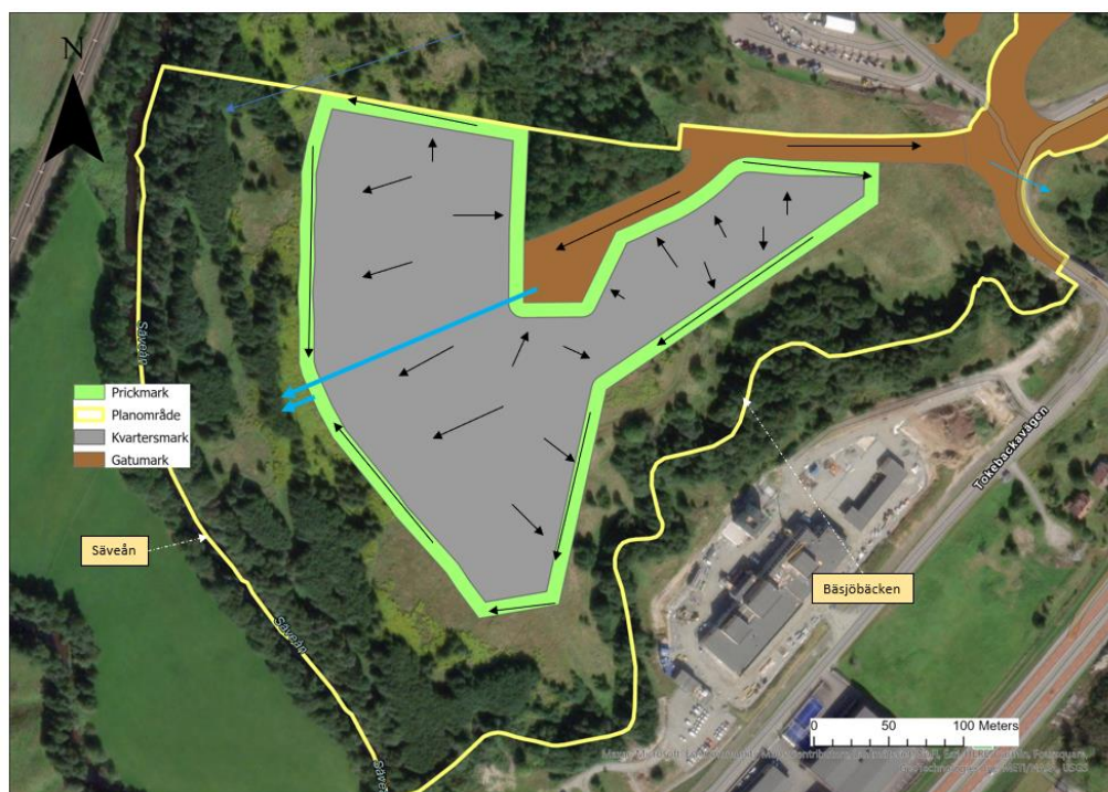
Figur 27. Delområdet i söder. Riktning på avrinningsvägar är enligt svarta pilar. Renat dagvatten från allmän platsmark och kvartermark (blåa pilar) mynnar ut i Säveån. Delar av vägen som vetter österut avrinner mot Bäsjobäcken. Avrinning från naturmarken uppströms bör ledas förbi planområdet.
