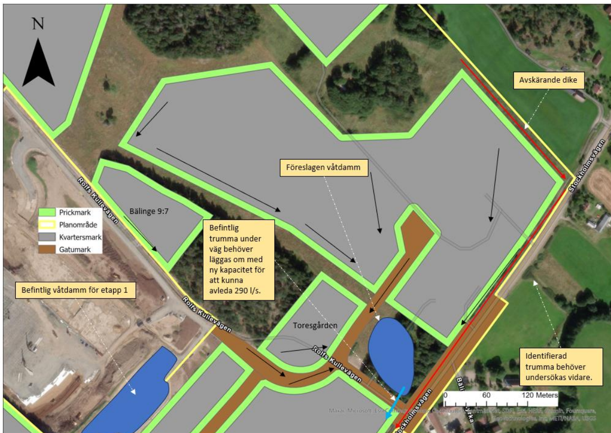
Figur 25. Avrinningsriktning från exploaterade ytor rekommenderas att ledas enligt svarta pilar till föreslagen våtdamm. Övrig avrinning från uppströms kvartersmark rekommenderas att ledas separat med samma riktning mot nedströms. En trumma identifierades öster om Stockholmsvägen som troligen inte är ansluten till planområdet men vidare undersökning rekommenderas för att säkerställa detta. Avrinning från ytan utanför planområdet bör ledas genom ett separat avskärande dike längs med Stockholmsvägen. Utloppet kan mynna ut till trumman under Stockholmsvägen och sedan i Bäsjöbäcken.
