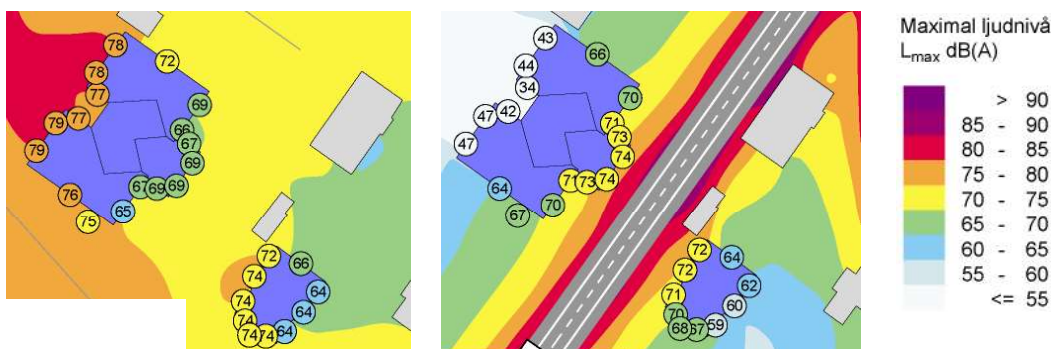
Kartan till vänster visar hur de befintliga bostäderna påverkas av maximala ljudnivåer från spårtrafiken på järnvägen vid situation "nollalternativ". Kartan till höger visar hur de befintliga bostäderna påverkas av maximala ljudnivåer från vägtrafiken på den nya genomfartsgatan vid situation "framtid". De maximala ljudnivåerna från spårtrafiken överskrider riktvärdena i framtiden även utan detaljplanens genomförande och de maximala ljudnivåerna från vägtrafiken klaras.
