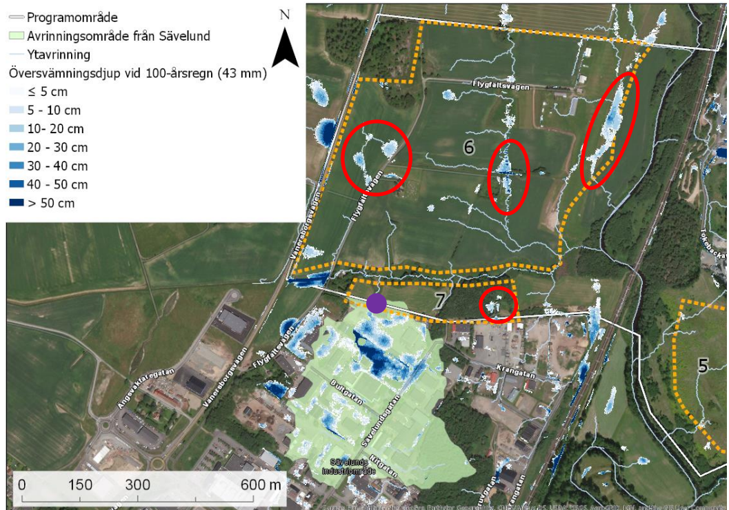
Figur 28. Översvämningsytor som uppstår i områdets västra del vid 100-årsregn (43 mm) samt rinnstråk (ljusblått). Även avrinningsområdet till den lila punkten är inritat för att visa inkommande vatten från Sävelund vid skyfall. Inringat i rött är stora översvämningsytor.
